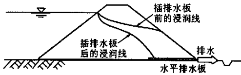
图2 水平排水板工法的工作原理
